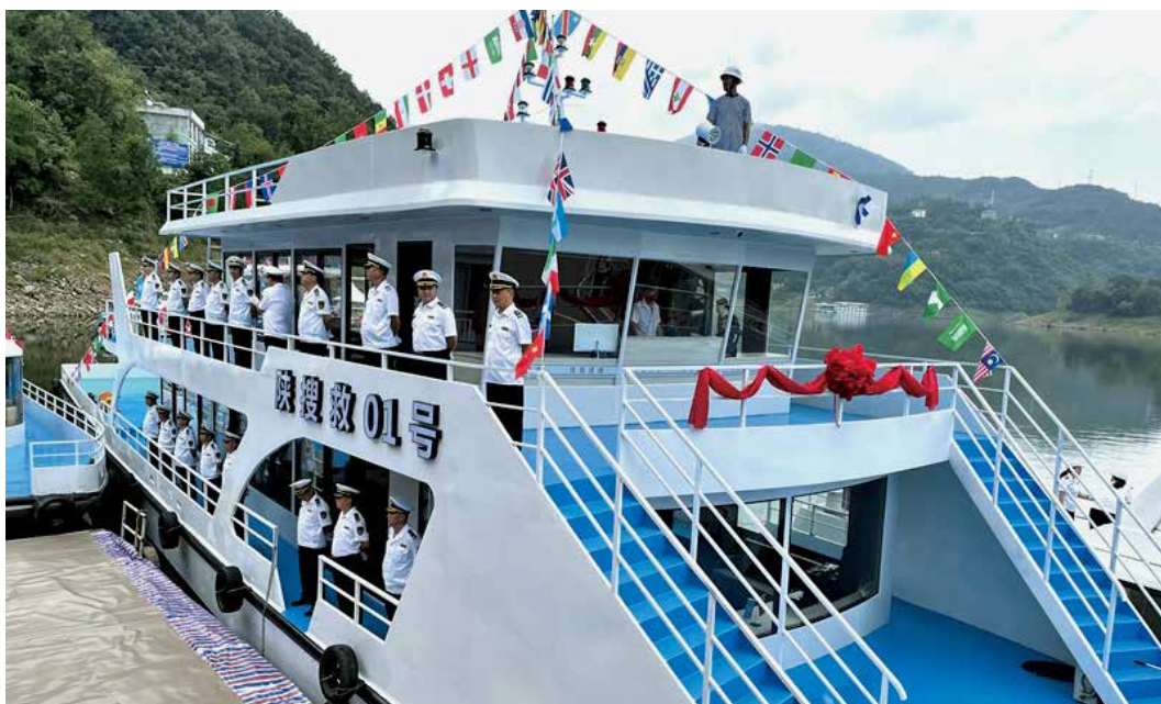
2021年8月19日，“陕西搜救01号”船长29.82米，型宽7.80米，型深1.8米，总吨204，双机480千瓦，航速30公里/小时。具有功率大、航速快、适应范围广、抢险能力强等特点，兼具搜救拖带、消防、打捞、防止船舶水污染、救助指挥等多项功能（安康市交通运输局）
