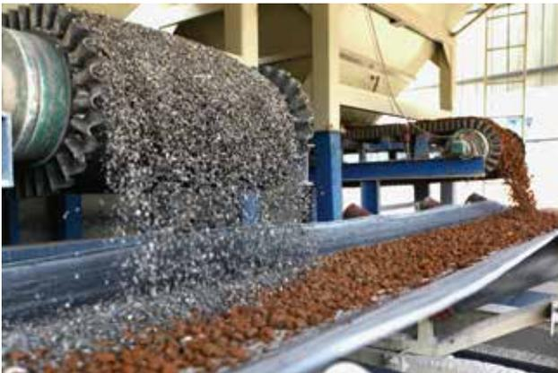
建筑垃圾再生材料应用于路面底基层
